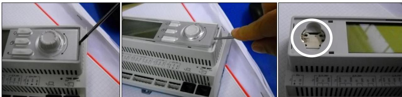
Seien Sie vorsichtig, damit die Kunststoffabdeckung nicht beschädigt wird. Dann die neue Batterie ordnungsgemäß in die Halterung (siehe markierter Bereich auf der nachfolgenden Abbildung) einsetzen und dabei auf die richtige, in der Halterung gekennzeichnete Polarität achten.
