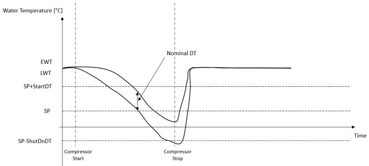
2. Réduction de la quantité de démarrage/arrêt du compresseur → Contrôle thermostatique moins précis.
