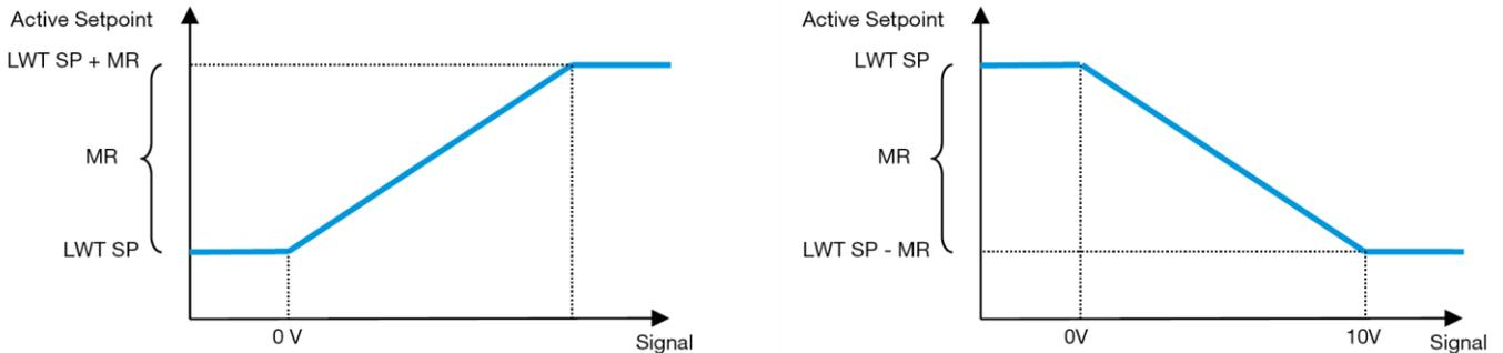
**Graphique 2 –Signal externe 0-10 V vs Point de consigne actif - Mode de refroidissement (à gauche) / Mode de chauffage (à droite)**
