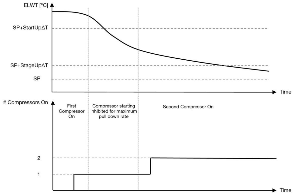
График 1 – Порядок запуска компрессоров — режим охлаждения
