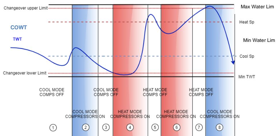
Для поддержания нормального терморегулирования на этапах 1-2-3 значение Start-Up разрешает включить охладитель в режиме охлаждения и охлаждать воду до температуры Shut-dn. Затем агрегат выключает компрессор и находится в режиме ожидания запроса нагрузки для повторного включения.
