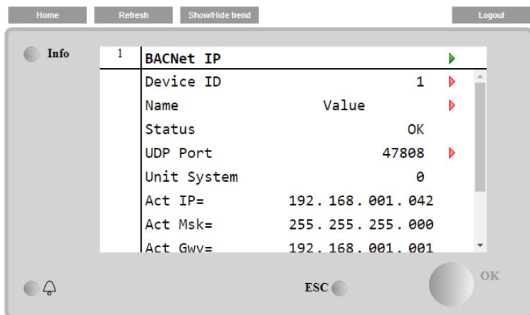
Для связи BACNet IP используется порт T-IP Ethernet (порт для соединения LAN), который также используется для дистанционного управления контроллером на ПК.
