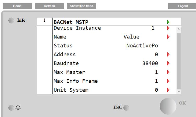
Чтобы установить связь, используется порт RS485 на выходах T14 контроллера МТ4.
