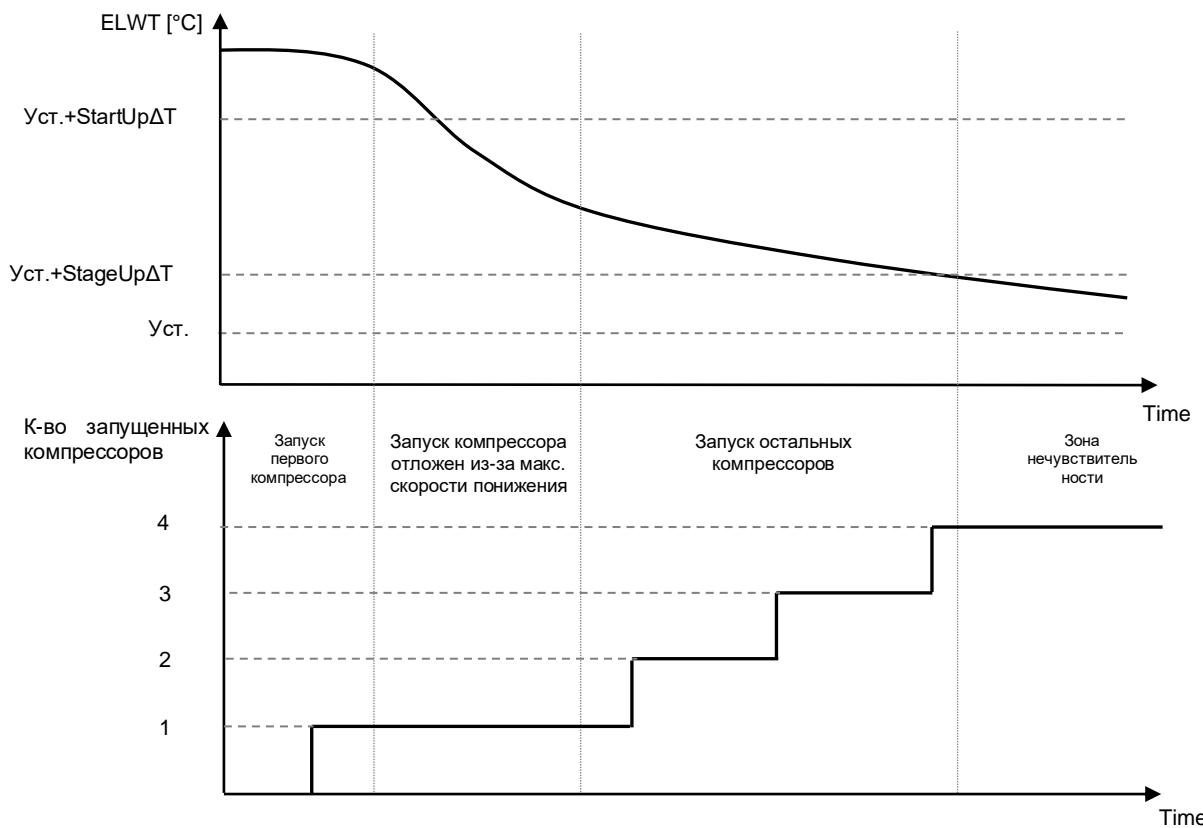
Настройки управления терморегулятором доступны в **Main Page (Главная страница)→Thermostatic Control (Терморегулятор)**
