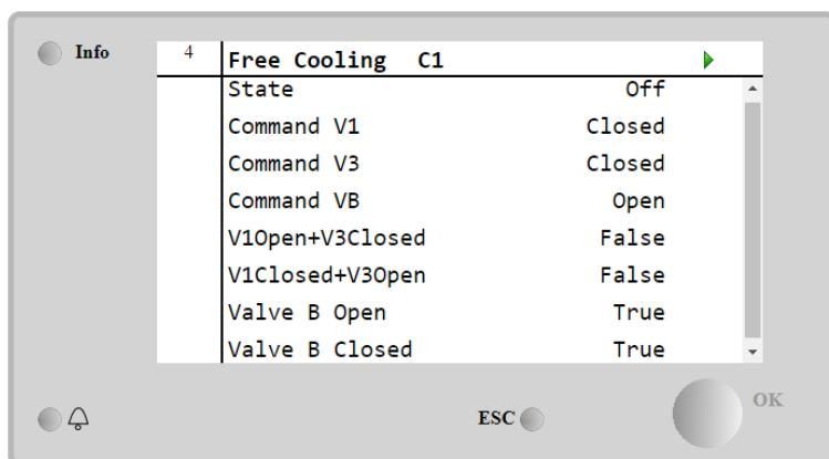
Рис. 1. Клапаны контура 1
