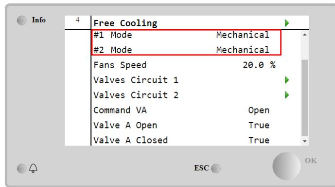
На этой странице можно войти на страницы Valves Circuit 1 («Клапаны контура 1») и Valves Circuit 2 («Клапаны контура 2»), которые включают:
