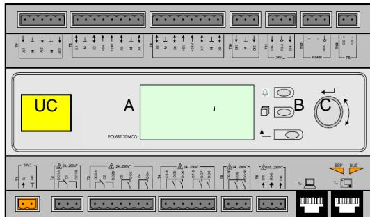
Клавиатура/дисплей (A) включает в себя 5-строчный дисплей из 22 символов. Ниже указаны функции трех кнопок (B):
