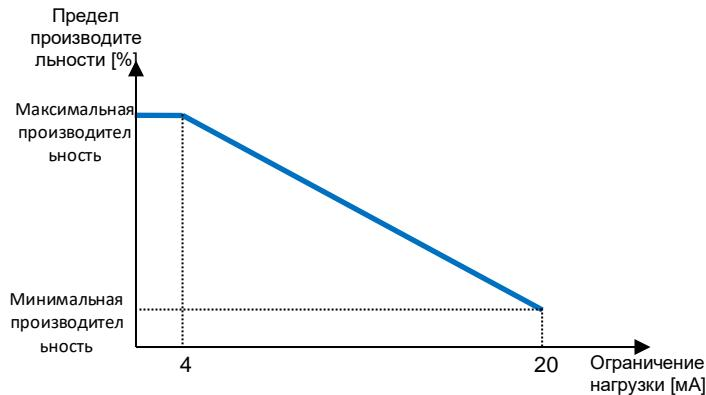
**График 1. Зависимость ограничения нагрузки ([mA] от предела производительности [%])**
