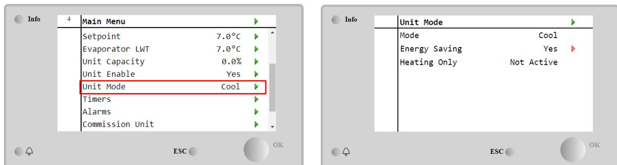
В зависимости от типа агрегата, в меню **режима работы агрегата** по служебному паролю можно выбрать разные режимы работы. В нижеприведенной таблице перечислены все режимы с разъяснениями.
