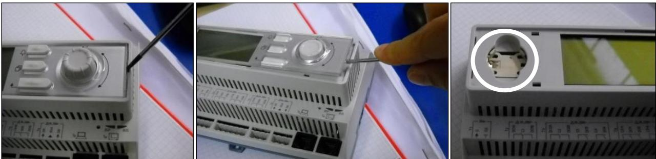
Следует избегать повреждения пластмассовой крышки. Новая батарея устанавливается в соответствующий отсек (см. обозначение на рисунке) с соблюдением полярности, указанной внутри отсека.
