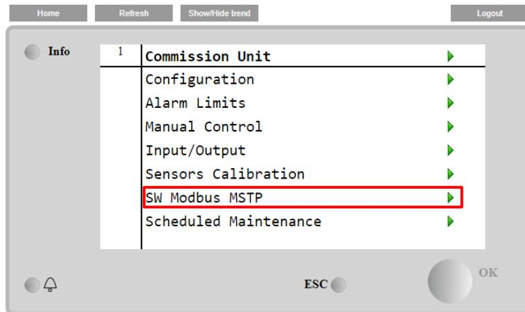
Могут быть заданы те же значения, что и на странице опции Modbus MSTP, с соответствующим драйвером и зависящие от конкретной системы, в которой установлен агрегат.
