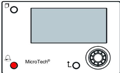
Длину кабеля дистанционного ЧМИ можно увеличить до 700 м, используя подключение через технологическую шину на UC. По гирляндной схеме один ЧМИ может быть подключен к 8 контроллерам (см. ниже). Подробную информацию см. в отдельном руководстве для ЧМИ.
