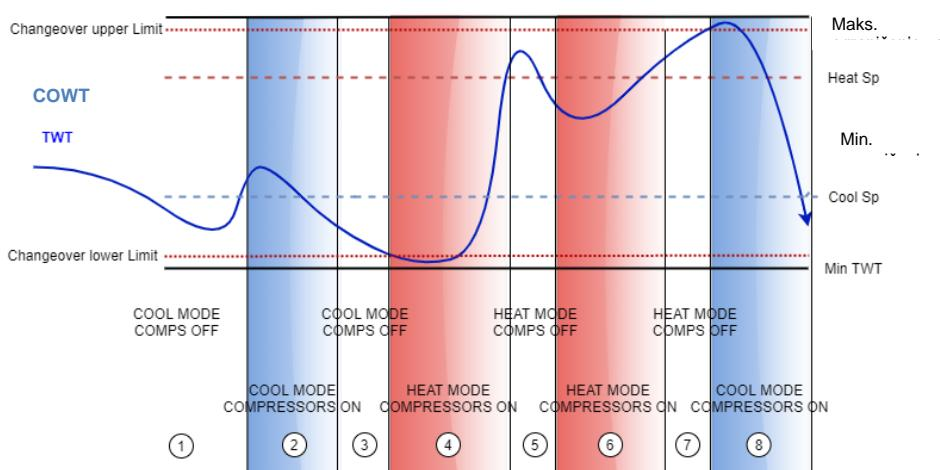
Kako bi se prilagodila uobičajena logika termoregulacije, u fazama 1-2-3 vrijednost Start Up omogućuje rashladniku da se uključi u hladnom načinu rada i ohladi vodu do temperature Shut-dn, gdje jedinica isključuje kompresor i čeka da se opterećenje ponovno uključi.
