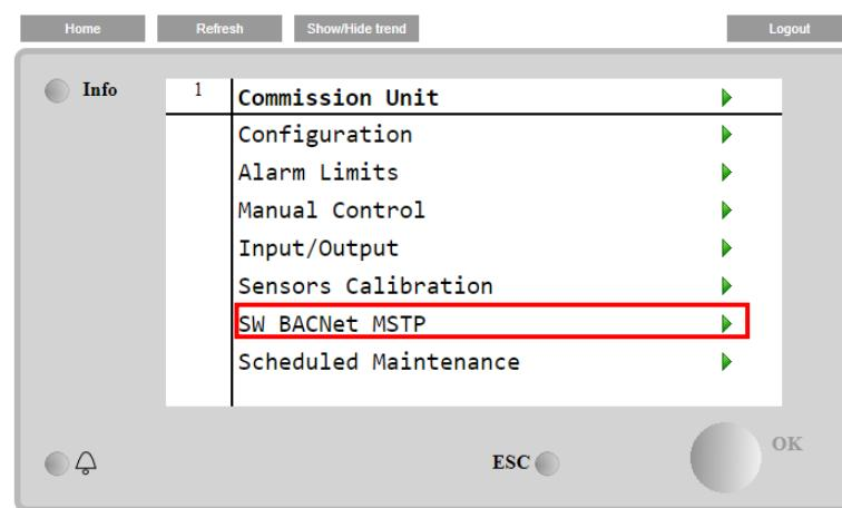
Vrijednosti koje se mogu postaviti jednake su onima koje se nalaze na BACNet MSTP stranici s relativnim pokretačem i ovise o određenom sustavu u kojem je jedinica instalirana.
