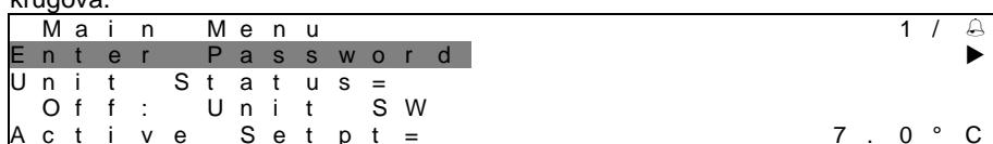
Aktivna stavka istaknuta je nasuprot tome, u ovom primjeru stavka istaknuta u glavnom izborniku poveznica je na drugu stranicu. Pritisakom na push'n'roll, HMI će skočiti na drugu stranicu. U tom slučaju HMI će skočiti na stranicu Enter Password.
