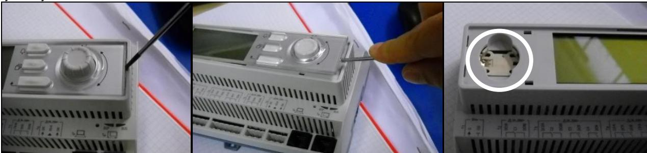
Pazite da ne oštetite plastični poklopac. Nova baterija mora se staviti u odgovarajući držač baterije koji je istaknut na sljedećoj slici, poštujući polaritete navedene u samom držaču.
