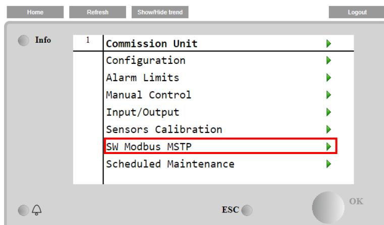
Vrijednosti koje se mogu postaviti jednake su onima koje se nalaze na Modbus MSTP stranici s relativnim pokretačem i ovise o određenom sustavu u kojem je jedinica instalirana.
