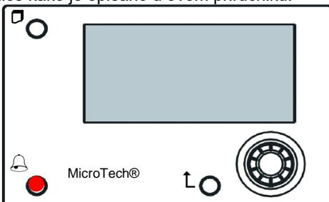
Daljinski HMI može se proširiti do 700 m pomoću priključka procesne sabirnice dostupnog na UC. Sa spojem lanaca tratinčica kao u nastavku, jedan HMI može se spojiti na do 8 jedinica. Pojedinosti potražite u posebnom priručniku za HMI.
