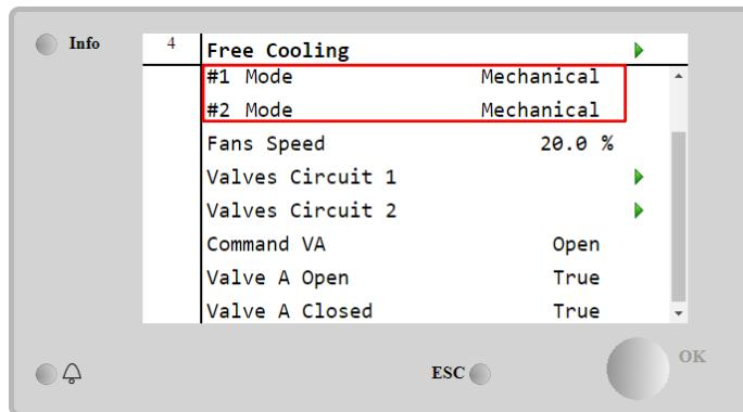
Σε αυτή τη σελίδα είναι δυνατή η πλοιήγηση στις σελίδες «Κύκλωμα βαλβίδων 1» και «Κύκλωμα βαλβίδων 2», οι οποίες και οι δύο περιλαμβάνουν:
