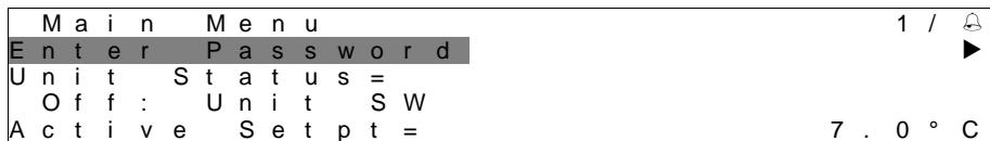
Το ενεργό στοιχείο τονίζεται με αντίθεση, σε αυτό το παράδειγμα το τονισμένο στοιχείο στο Κύριο μενού είναι ένας σύνδεσμος σε άλλη σελίδα. Με πίεση του χειριστήριου push & roll, το HMI θα μεταπήδησε σε διαφορετική σελίδα. Σε αυτήν την περίπτωση το HMI θα μεταπήδησε στη σελίδα Εισαγωγή κωδικού πρόσβασης.
