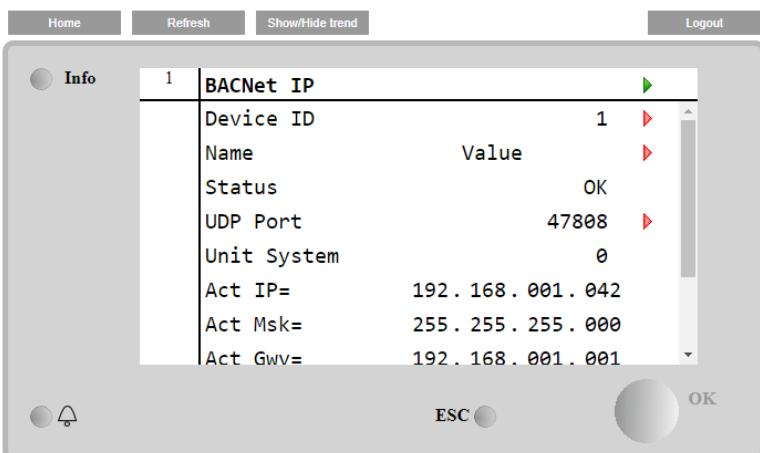
Η θύρα για σύνδεση LAN που θα χρησιμοποιηθεί για την επικοινωνία BACNet IP είναι η θύρα T-IP Ethernet, η ίδια που χρησιμοποιείται για τον απομακρυσμένο έλεγχο του ελεγκτή στο PC.
