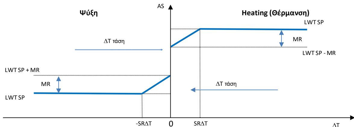
**Γράφημα 4 Έναρ ΔΤ (Διαφορά θερμοκρασίας για εξατμιστή) και Ενεργό Σημείο Ορισμού - Λειτουργία Ψύξης (αριστερά) / Λειτουργία Θέρμανσης (δεξιά)**
