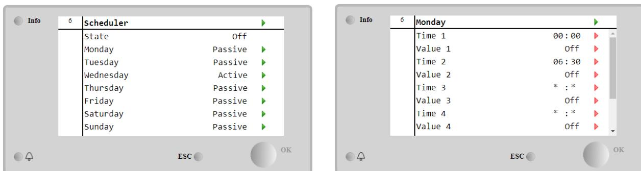
За всеки ден от седмицата могат да се програмират до шест времеви диапазона с определен режим на работа. Първият работен режим започва в Time 1, завършва в Time 2, когато ще започне вторият работен режим и така нататък до последния.
