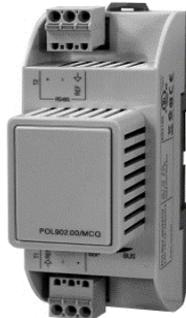
Im Fall einer Modbus-Verbindung mit einer BMS, muss das entsprechende Modul an der Einheit (POL902) installiert werden. Es muss wie im vorherigen Abschnitt beschrieben, an die Controller-Einheit angeschlossen werden.
