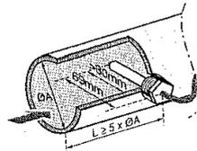
Wählen Sie die Einbauposition so, dass die Kabellänge des Sensors (10 m) ausreichend lang ist.
