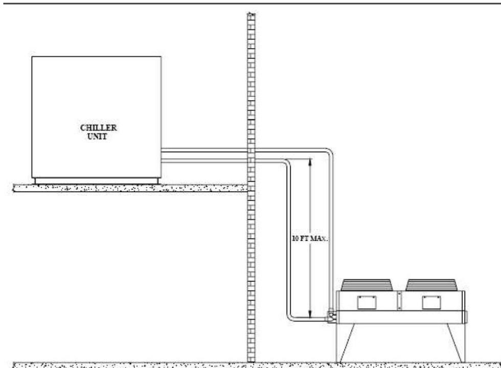
Abbildung 7 - Verflüssiger unterhalb des Geräts angeordnet
