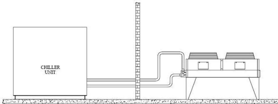
**Abbildung 5 - Standort des Verflüssigers ohne Höhenunterschied**
