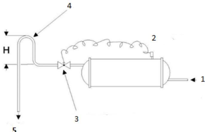
Рис. 12. Схема управления конденсацией при использовании артезианской воды
