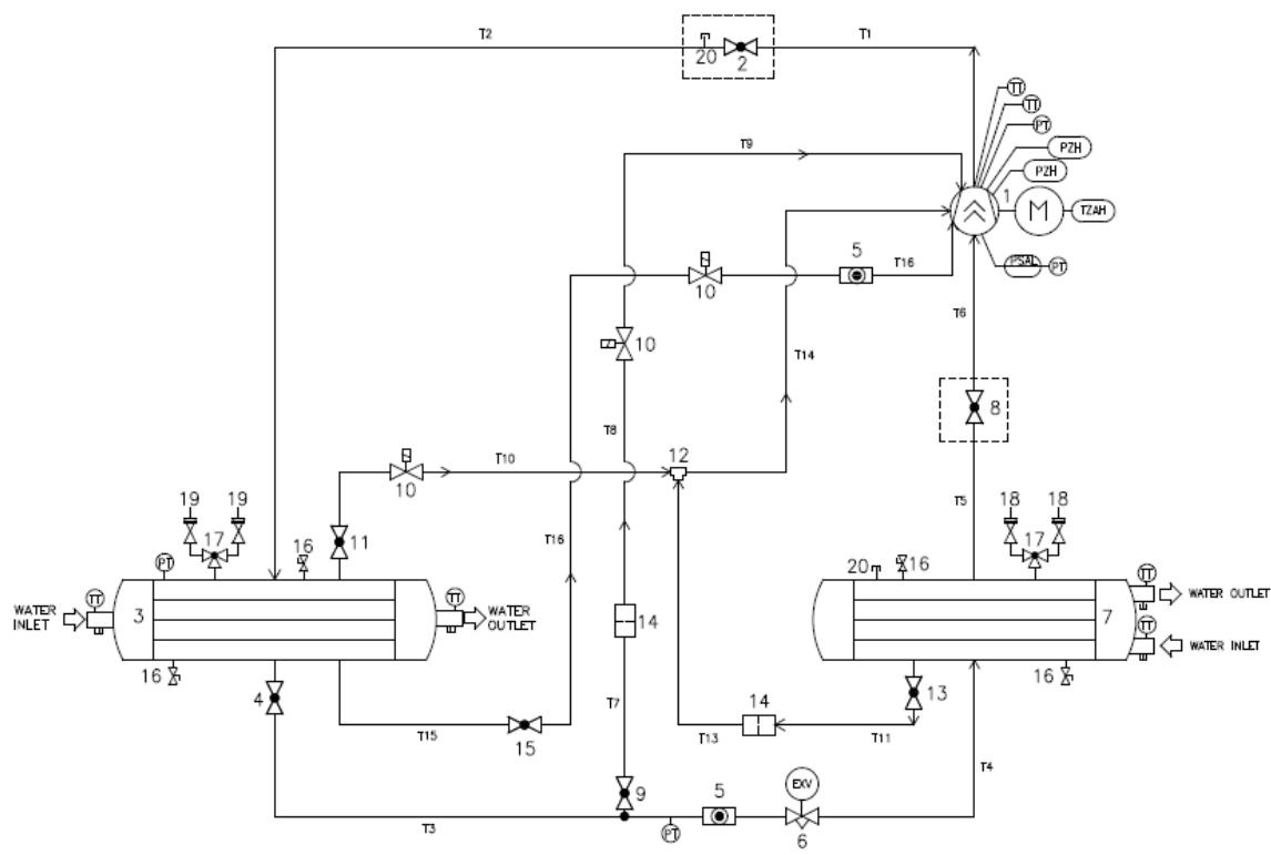
Рис.14.Типовой одноконтурный контур охлаждения
