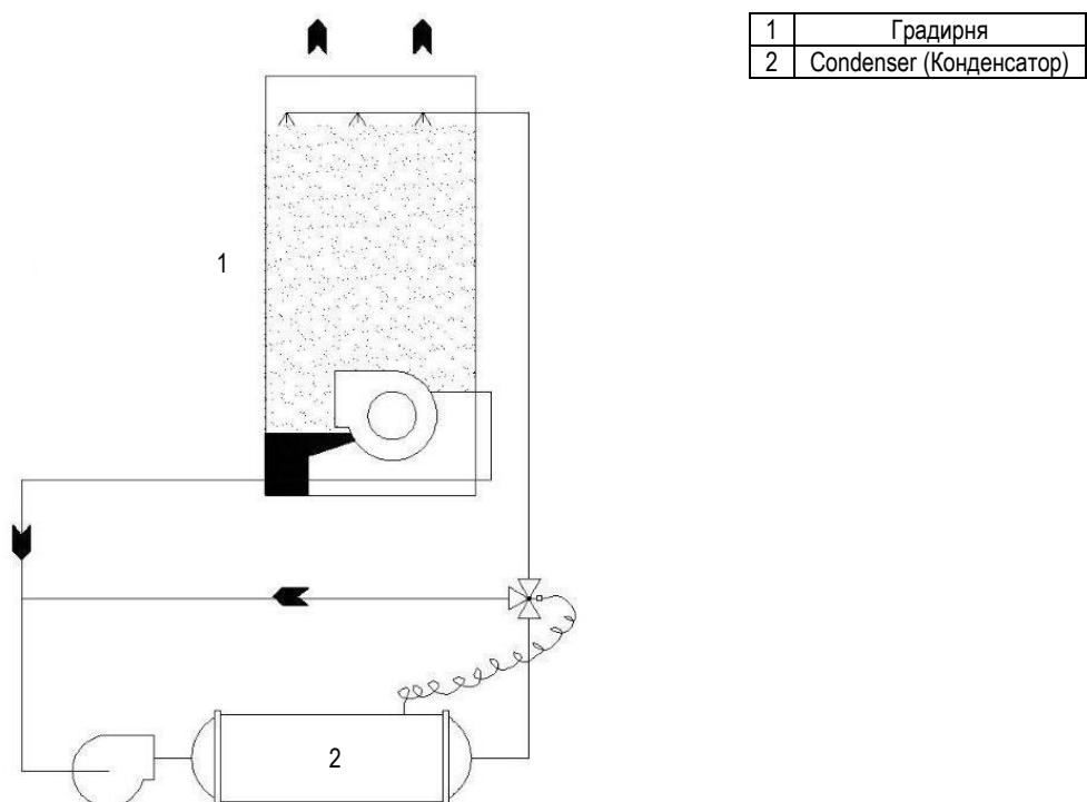
Рис. 11. Схема управления конденсатором с градирней
