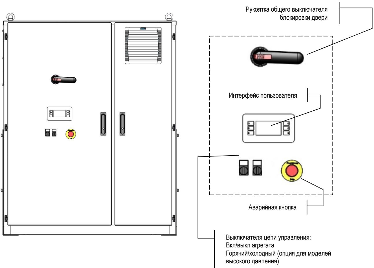
Рис. 13. Интерфейс агрегата
