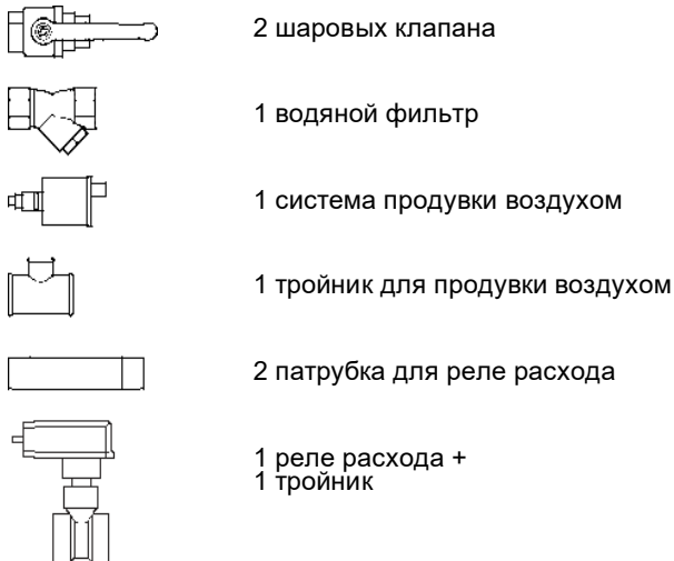
Рис. 8. Водопровод испарителя, пластиковый пакет 1
