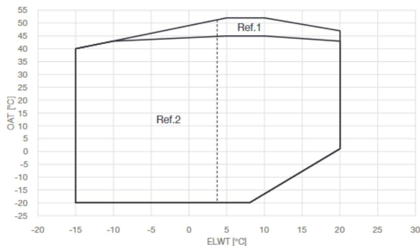
**Εικόνα 15 - Όρια λειτουργίας στο EWYTCZ σε λειτουργία ψύξης**
