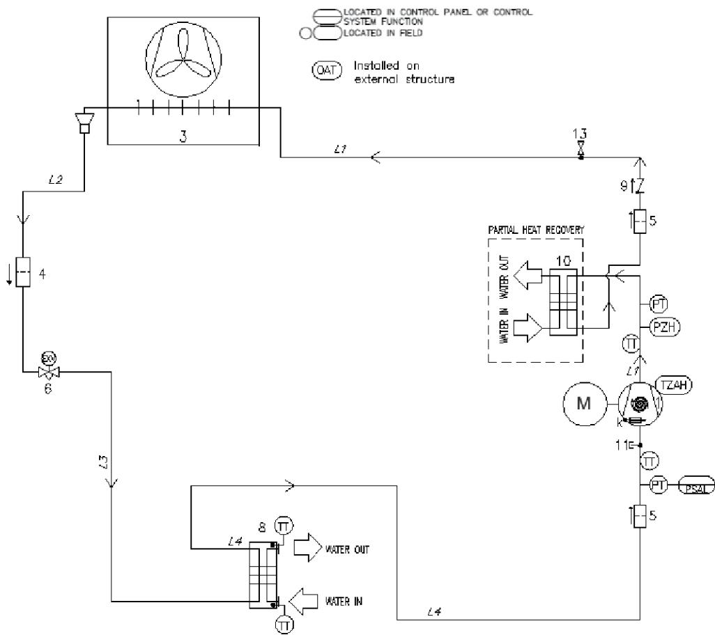
Εικόνα 20 - Διάγραμμα κυκλώματος ψυκτικού μέσου (P&ID) για μονάδα ΜΟΝΟΥ κυκλώματος ΕWAT~CZ
