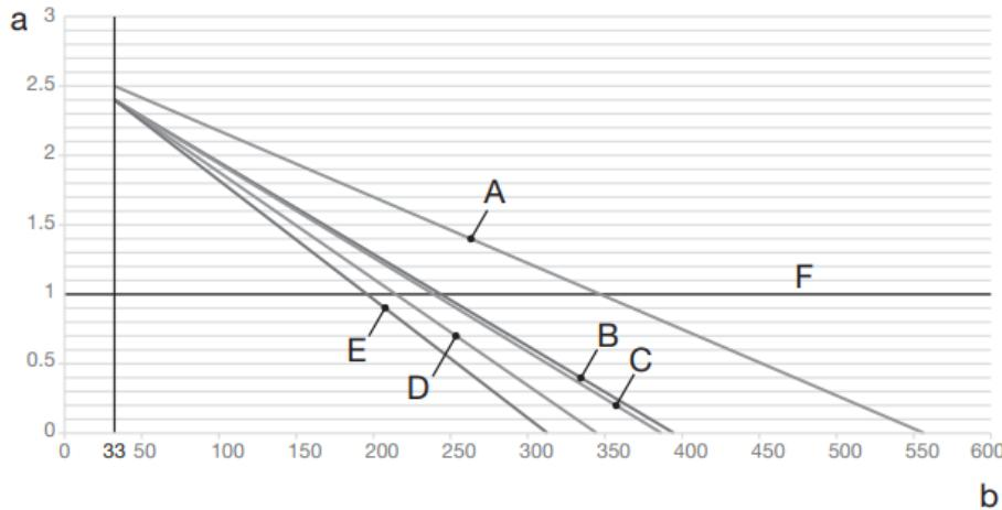
**Εικόνα 18 - Αρχική πίεση δοχείου διαστολής με βάση τον μέγιστο όγκο νερού**
