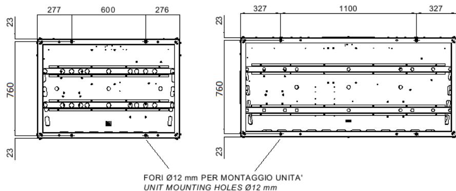
**Εικόνα-5 – Θέση οπών στερέωσης (κάτω όψη)**
