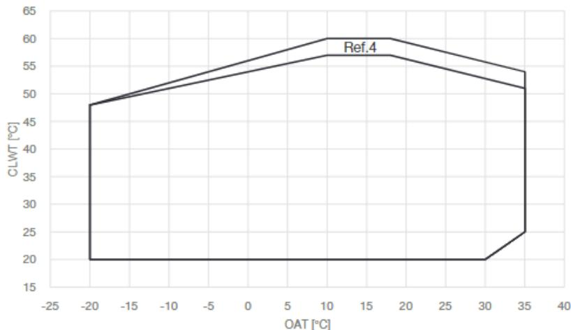
Εικόνα 16 - Όρια λειτουργίας στο EWYT CZ σε λειτουργία θέρμανσης
