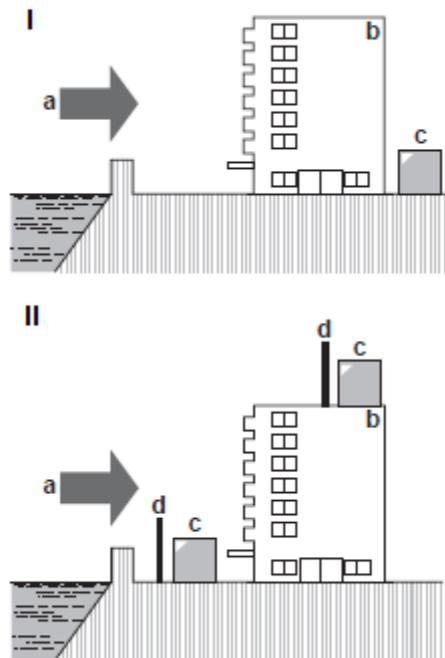
Figura 9 –Instalação à beira-mar da unidade exterior
