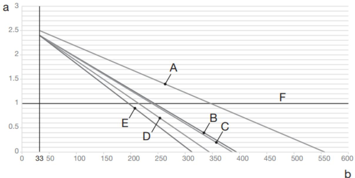
**Figura 18 - Pressão inicial do vaso de expansão com base no volume máximo de água**
