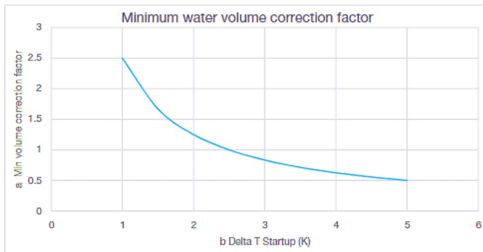
**Figura 17 - Fator mínimo de correção do volume de água**
