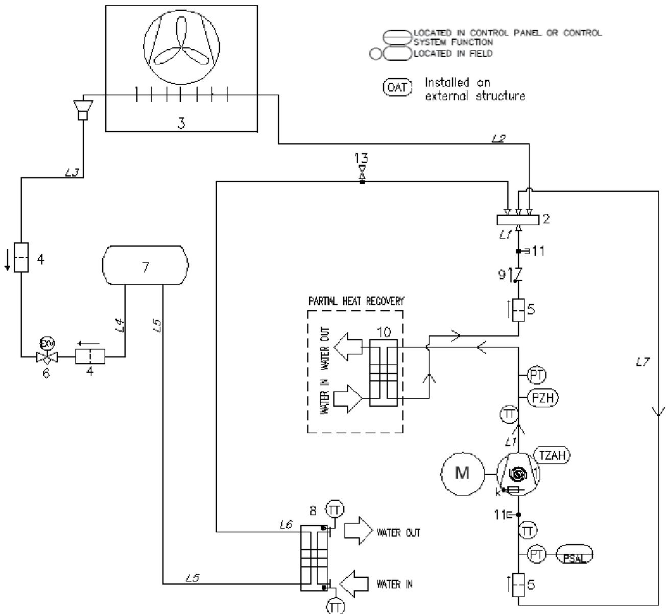
Figura 19 - Esquema do circuito de refrigeração (P&ID) para a unidade EWYT ~CZ circuito MONO
