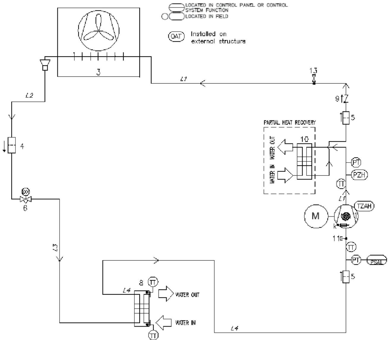
Figura 20 - Esquema do circuito de refrigeração (P&ID) para a unidade EWAT ~CZ circuito MONO
