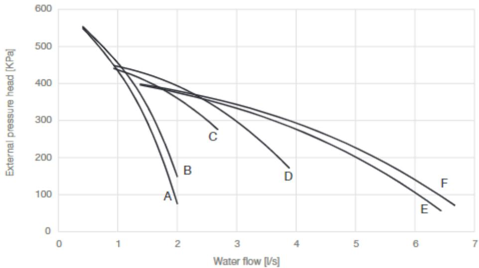
**Figura 13 - Cabeçote de pressão externa de elevação alta da bomba**
