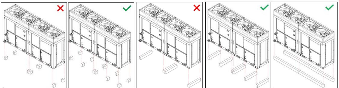
Figura 4 –Posicionamento da unidade DUAL
