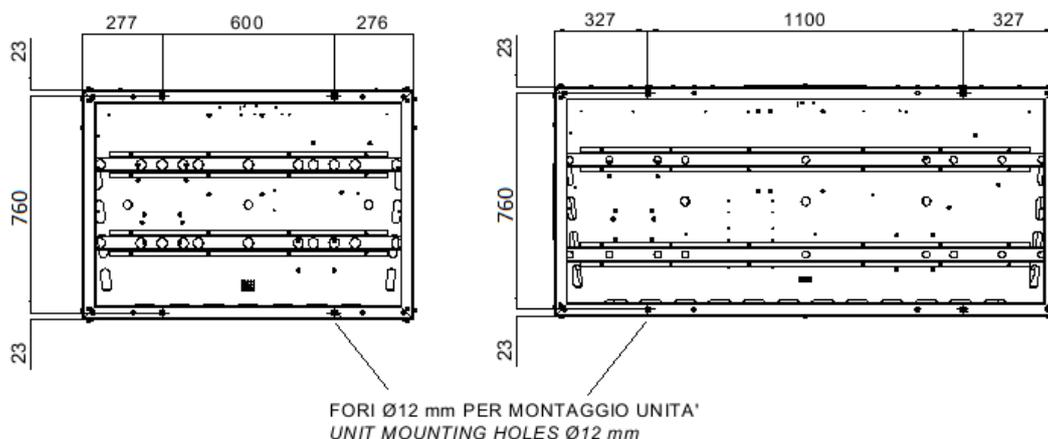
**Figura 5 –Localização dos orifícios de montagem (vista inferior)**
