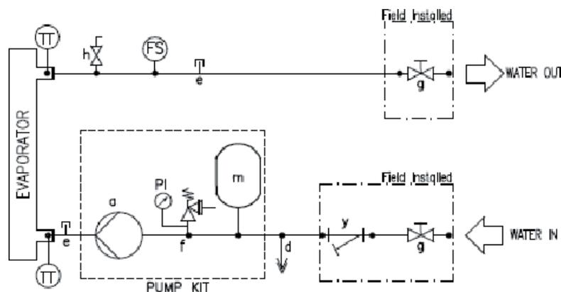
Figura 10 –Diagrama hidráulico
