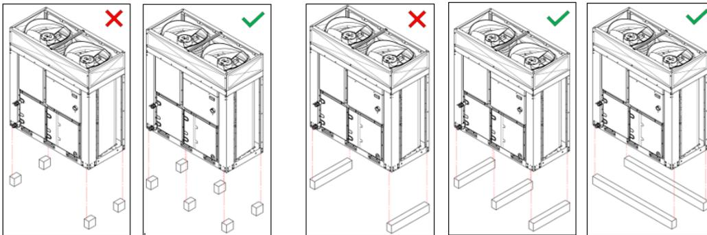
Figura 3 –Posicionamento da unidade MONO
