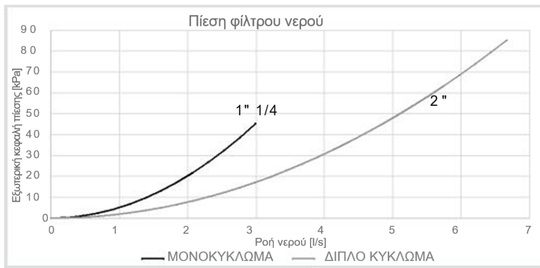
Εικόνα 11 - Πτώσεις πίεσης του φίλτρου νερού
