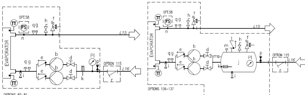
**Εικ. 9 – Διάγραμμα υδραυλικού κυκλώματος για διπλή αντλία (EWYTx5B) (επιλογές 80-81/136-137)
