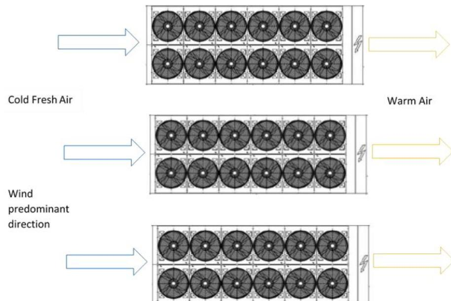
Εικ. 4 – Εγκατάσταση πολλών μονάδων (λειτουργία ψύξης)
