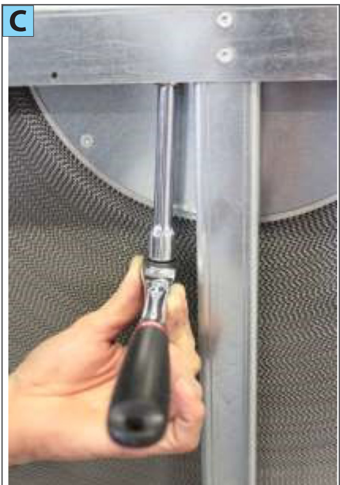
1) Slăbiți cele două șuruburi (foto C)
