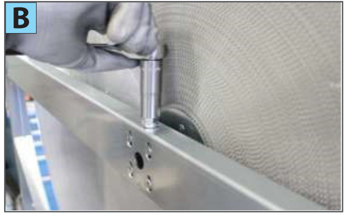
2) Die Konvergenz des Rades mit Hilfe des vertikalen Bolzens einstellen (Foto B)
