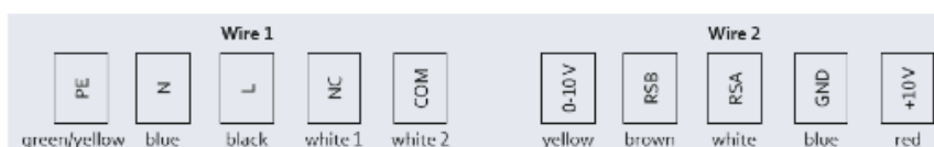
Tipul 4 cu cabluri de conexiune
