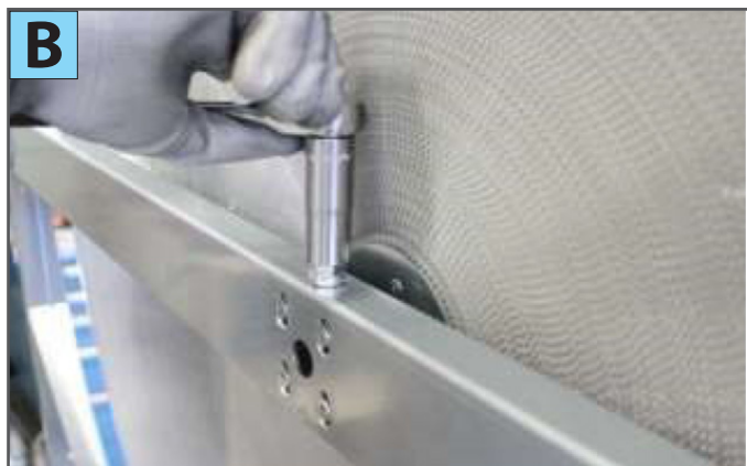
2) Regule a convergência da roda usando o parafuso vertical (foto B)
