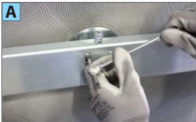
1) Draai de 4 schroeven los (foto A)
