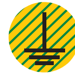
Mise à la terre
