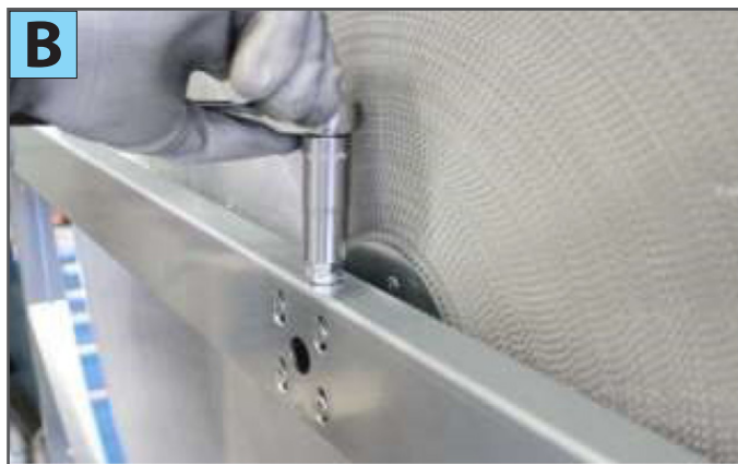
2) Régler la convergence de la roue au moyen du boulon vertical (photo B)
