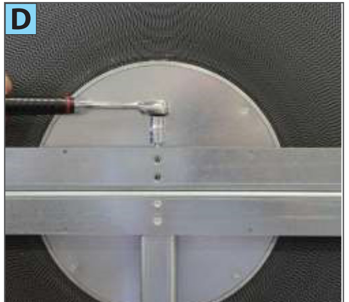
2) Die Konvergenz des Rades mit Hilfe der vertikalen Schraube einstellen (Foto D)
