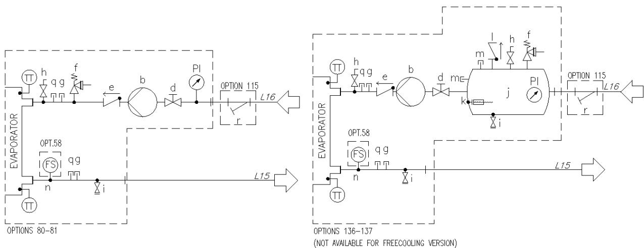
**Obr. 9 - Schéma hydraulické soustavy pro dvojité V (EWATxx5B) čerpadlo (vol. 80-81/136-137)**
