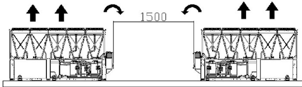
**Obr. 5 - Požadavky minimálního prostoru**
