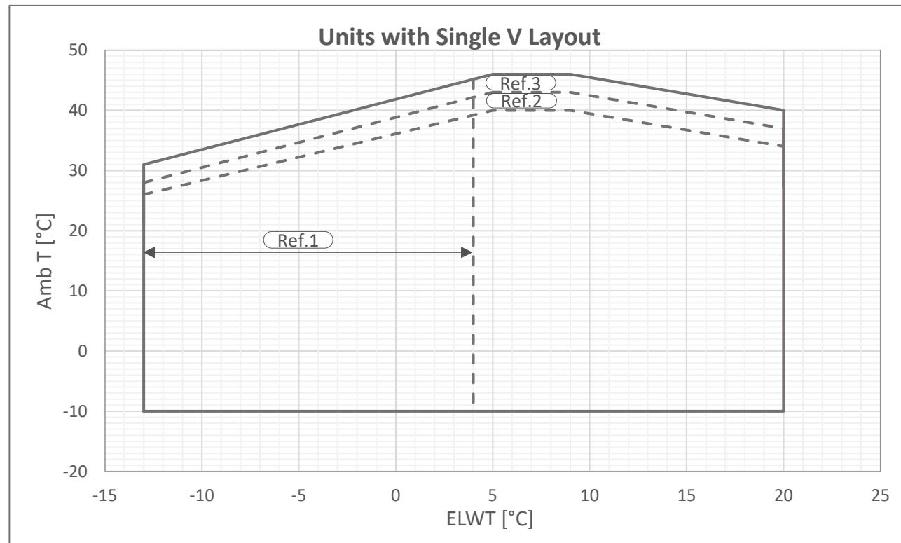
*Obr. 12 - Provozní limity Single V-Gold*
