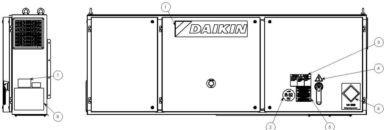
Obr. 16 - Popis štítku na elektrickém panelu
