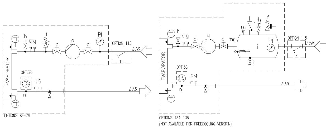
**Obr. 8 - Schéma hydraulické soustavy pro jednotlivé V (EWATxx5B) čerpadlo (vol. 78-79/134-135)**
