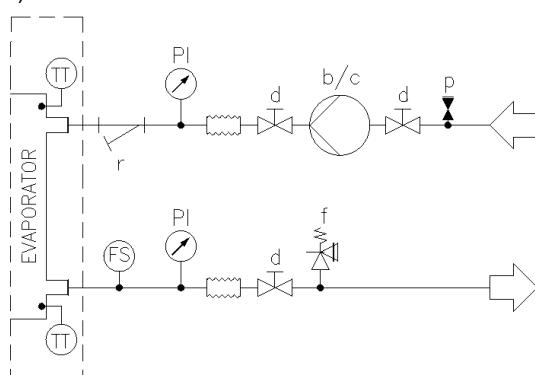
Obr. 7 - Nákres hydrauliky bez čerpadla (čerpadel) (max. provozní tlak 20 bar)
