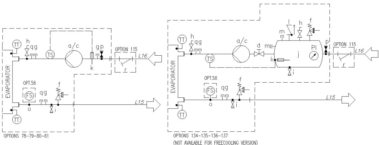
**Obr. 10 - Hydraulické schéma pro modulární V (EWATxx0B) (vol. 78-79-80-81/134-135-136-137)**
