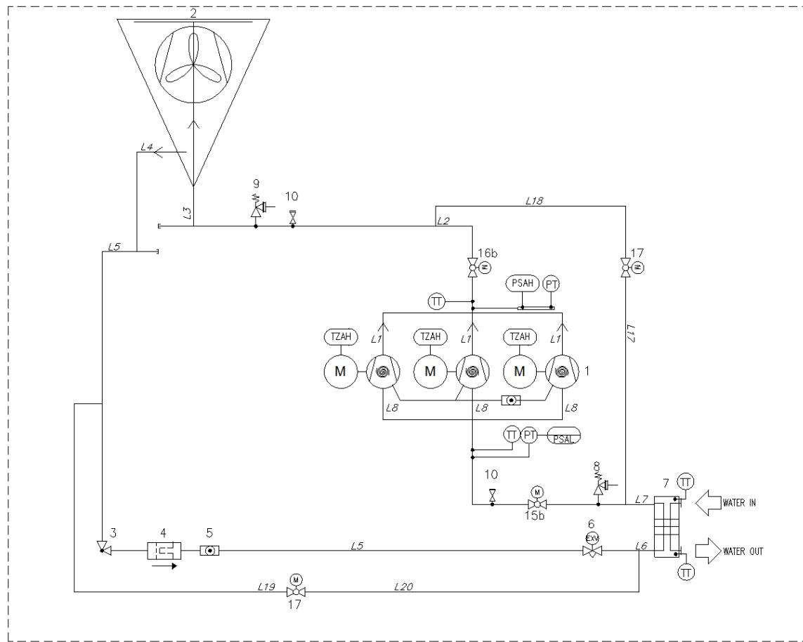
**Obr. 14 - Nákres chladicího okruhu (P&ID) jednotka se slabým chlazením venkovním vzduchem jedním okruhem**
