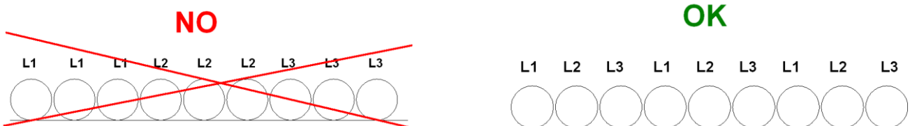
Obrázok 17 – Inštalácia dlhých napájacích káblov
