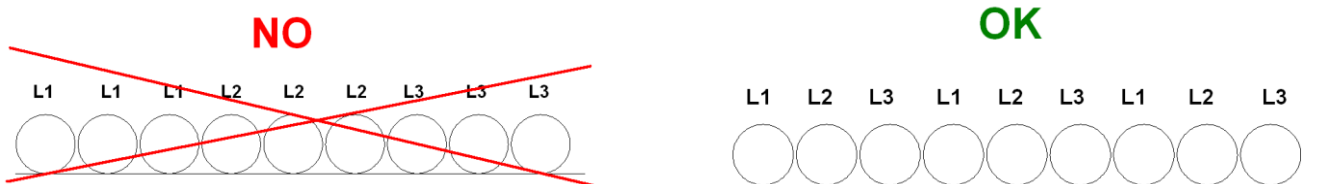
Figura 17 – Montarea cablurilor de alimentare lungi
