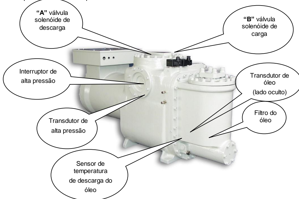
Figura 32 - Instalação dos dispositivos de comando do compressor Fr3100
