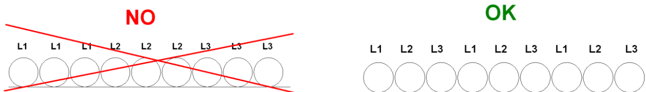
Figura 17 - Instalação de cabos de fornecimento eléctrico compridos
