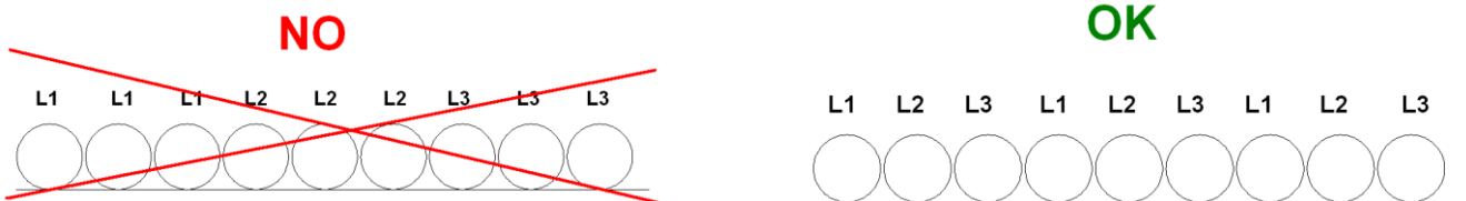
Rysunek 17 – ułożenie długich przewodów zasilających
