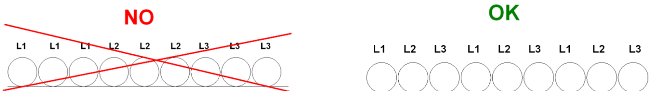
Afbeelding 17 - Installatie van lange voedingskabels
