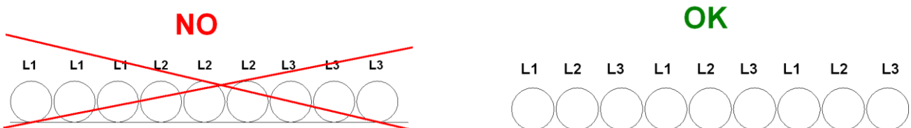
17.ábra - Hosszú tápvezetékek beszerelése
