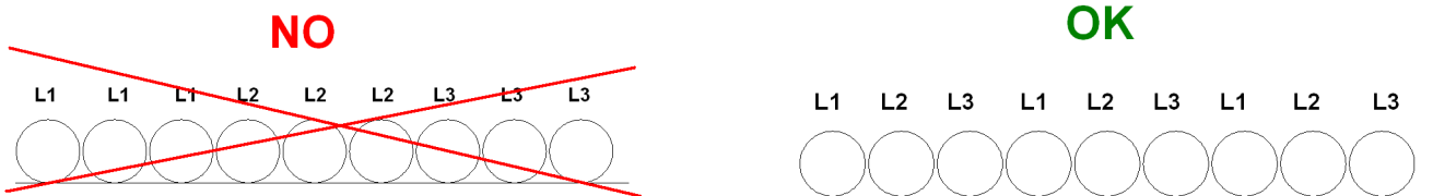
Figure 17 - Installation du câblage d'alimentation
