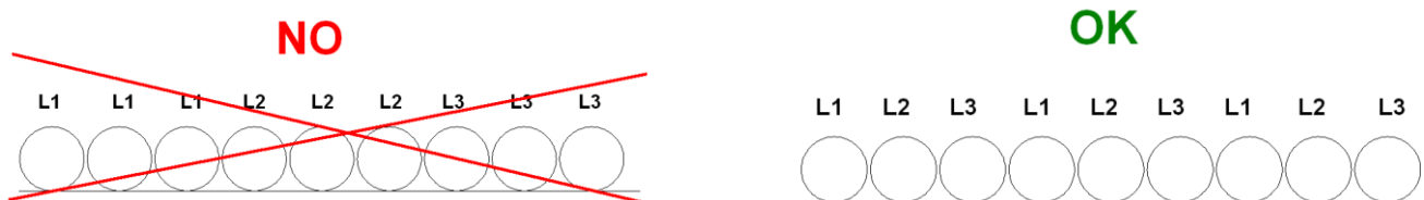
Figura 17 - Instalación de cables largos de energía
