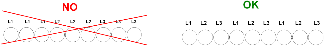
Εικόνα 17 - Εγκατάσταση μακρίων καλωδίων παροχής ρεύματος
