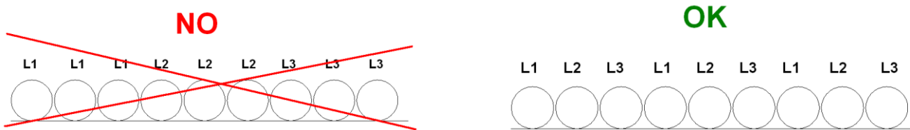
Obrázek 17 - Instalace dlouhých napájecích vodičů
