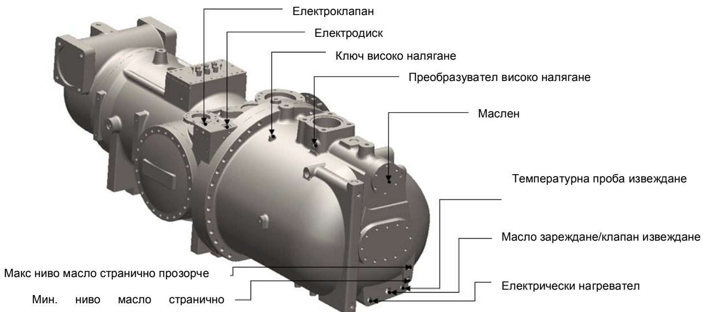
Схема 33 - Монтиране контролни уреди за Fr3 компресор
