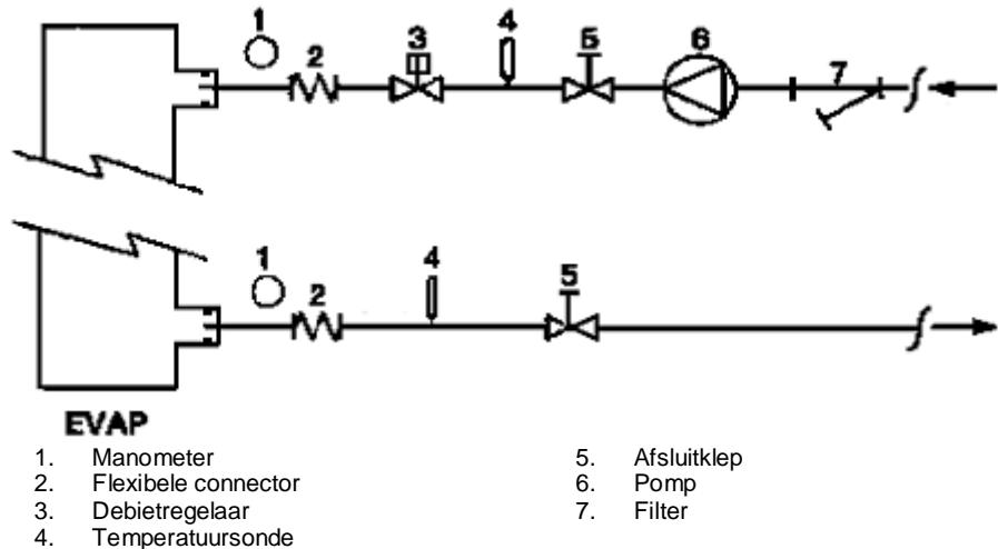
**Figuur 6 - Aansluiting van de waterleidingen voor de warmtewisselaars voor warmtere recuperatie**
