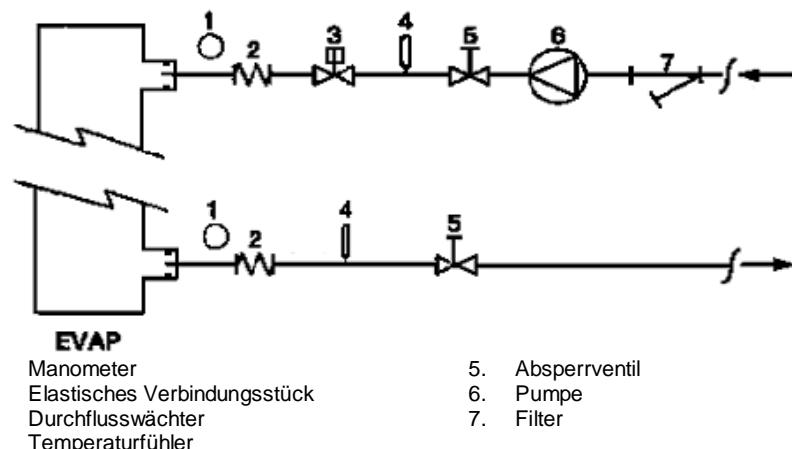
Abb. 6 - Wasseranschlüsse Wärmetauscher
