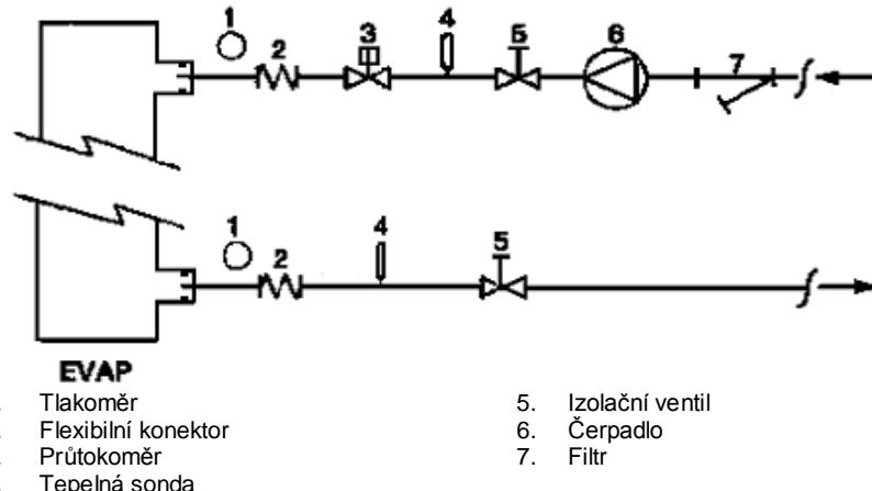
Obrázek 6 – Zapojení vodních trubek k výměníkům rekuperace tepla
